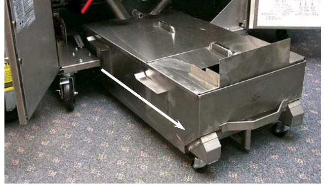
Filtre kabını fritöz kabininden çekerek çıkarın.
